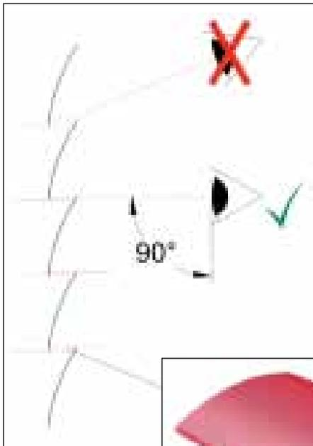
Bei rechtwinkliger Draufsicht auf die geschlossenen Lamellen darf keine Durchsicht möglich sein.
